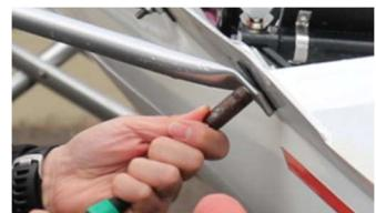
**バックスティ** メインステイを組み、オールロック・ピンの位置や角度の調整が終わったら、最後にバックスティを取り付けます。長さ調整機構をフリーにして(あるいは調整し), 艇側, ピン側のナットを固定してから, ホースクランプやターンバックルで確定します。
