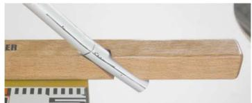
**バックスティ矯正器** 少しのバックスティの曲りは、簡単な矯正器で補正することができます。
