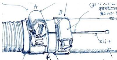
**ホースクランプ** バックスティを固定したら、リteinリングを確実にバックスティ本体側に押し当てる位置まで回し、それからホースクランプを、「ペロ」や突起ができるだけ漕手側に向かないような位置で固定します。また、本体側のホースクランプは、端から数ミリ開けて留めるようにします。ターンバックルのタイプは、両端のナットを緩め、ターンバックルを回すことで調整します。中央がずれないようにしなければなりません。
