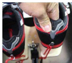
**調整範囲** シューズをかなり高くした設定も散見されます。シューズ・プレートを特注し、足底の最大加重ポイントを、ギアレールよりも上になるような設定です。その場合、ストレッチャーボード下端を引き上げる力も働き、設計荷重を越えた力がかかり、不測の損傷を起こすリスクもあります。艇の状態をよく見ておく必要があります。
