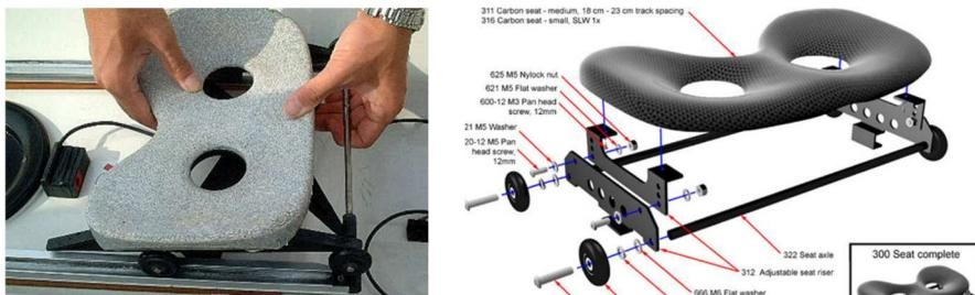
シートの着脱 シートの正しい着脱法を習得しておきましょう。ダブルアクションでは、キャリッジを前(スターン側)に寄せて前輪(スターン側)を外し、それから座面を前に寄せてから後輪を外します。シングルアクションでは、バックストップ(またはフロントストップ)を外してから、引き抜きます。取付けは、逆の手順です。
