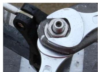
ゲートのロックナット オールロックのゲートにあるロックナット(ナイロンナット)は、オールロックの内寸に影響するので、ゲートを閉めたらノブを回してすぐにロックするように調整しましょう。
