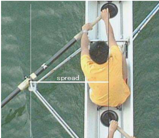
スプレッドは艇軸からソールピンまでの水平距離のこと
