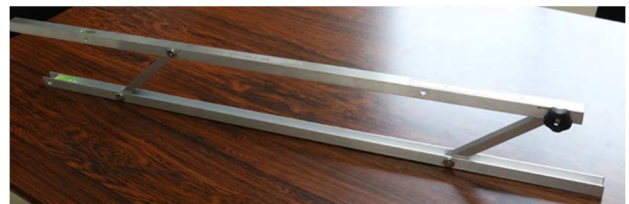
リガーに干渉せず、シートからオールロックを直接計測できるタイプ。
