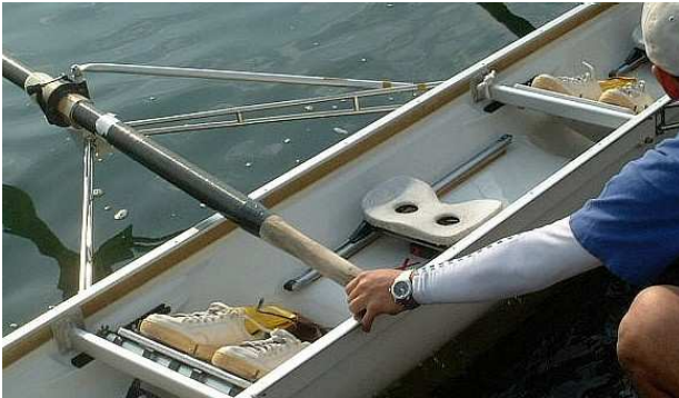
オールの支点(ピボット)を支えるアウトリガー
