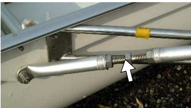
トップステイのターンバックル。左ネジに注意。
