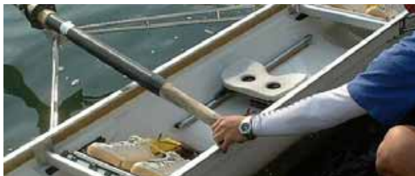
ガンネルとハンドルの端(バット)を合わせて持つ。
