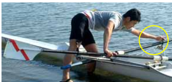
艇を浮かべたらまずオールロックのゲートを確実に締める。
