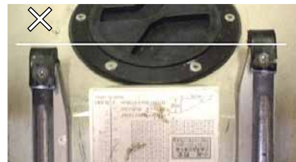
左右のレールは正確にそろえる. ずれると脱線の高まり.
