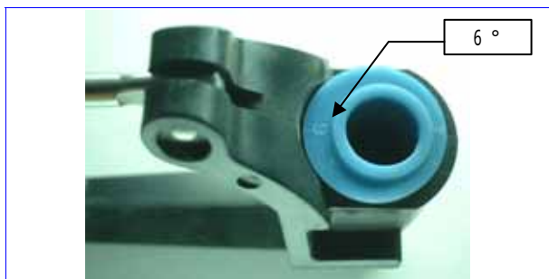
プッシュ(インサート)を交換し必要なオールロック固有角を造る。
