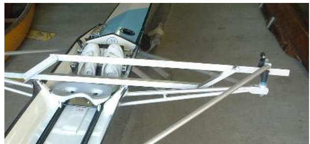
ガンネルからオールロックまでの高さの計測
