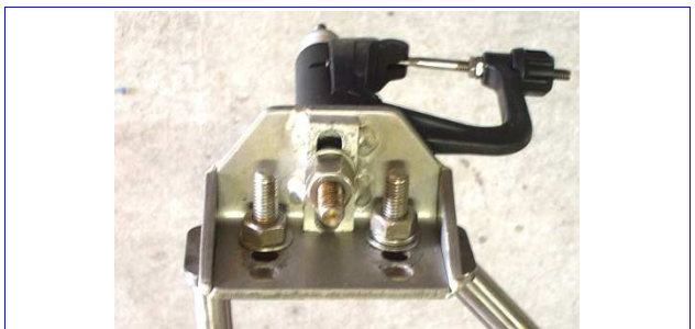
L板は孔の位置でハイトを調整できる
