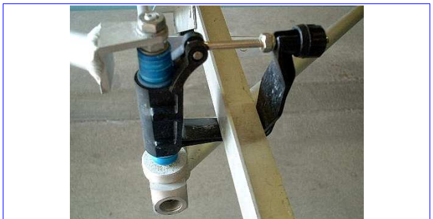
ハイトを計測するときは、「ミドルの位置で」シルの中心で
