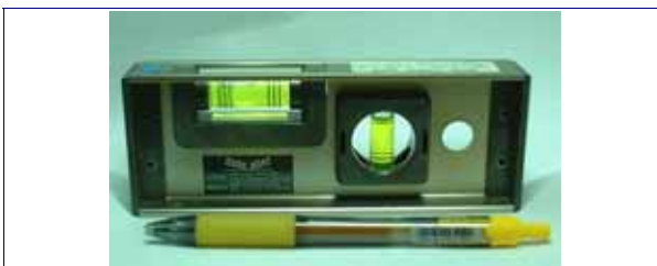
水準器。写真は短いものだが、長短2つくらいがあると便利。
