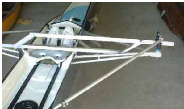
パンタグラフ型。リガーの干渉を避けることができる。さらにシートからオールロックまでを直接計測できる。
