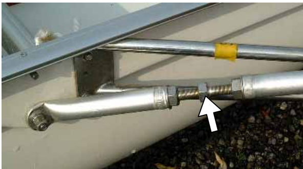
トップステイのターンバックル。左ネジに注意。
