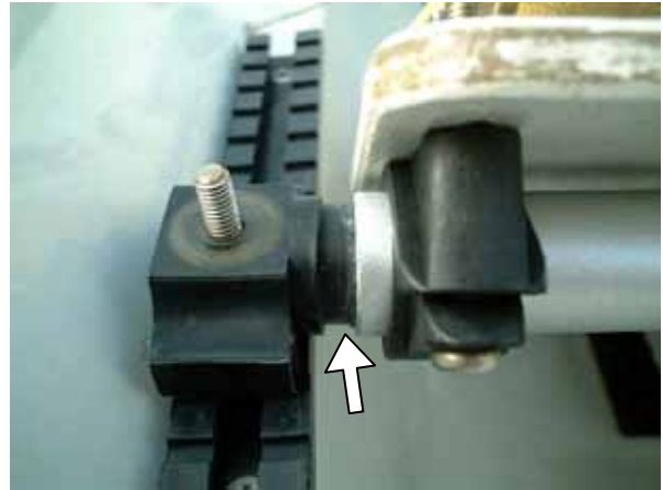
バーが抜け出ると、正しい位置に固定できず、艇にも無理がかかる
