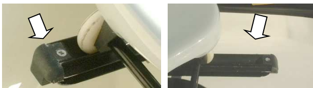
フロントストップ、バックストップは、小さいけれど大切な部品
