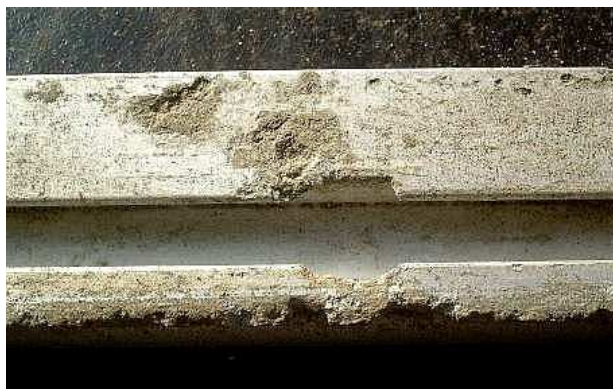
特に海域では、十分な水洗いをしないと軽合金の電食が進む。
