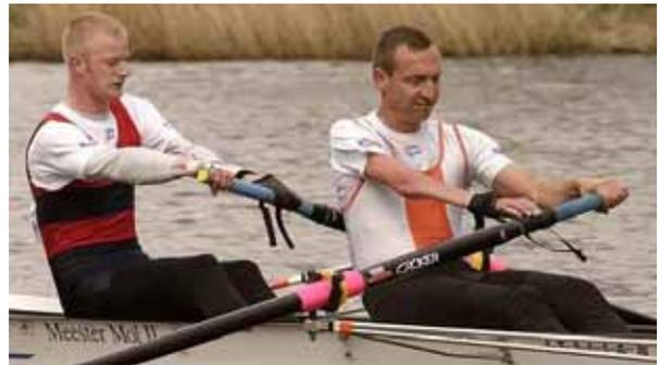
片手の障害に対し、ハーネスを工夫してハンドルとリンクさせ漕ぐ2 - www.NLRoei.nl の写真集より抜粋、オランダ TweeHead 2004 での風景
